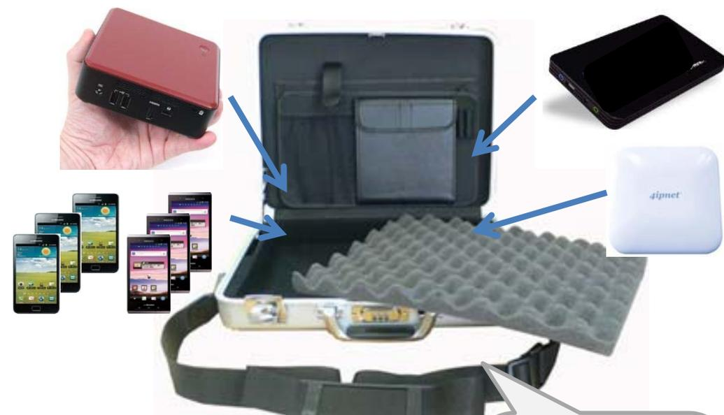
アタッシュケースに小型の構内交換機(IP-PBX)、Wi-Fi基地局、バッテリー、携帯端末(貸出用)など必要最低限の装置を収容して、被災地の避難所等で簡易に通信手段を確保。
