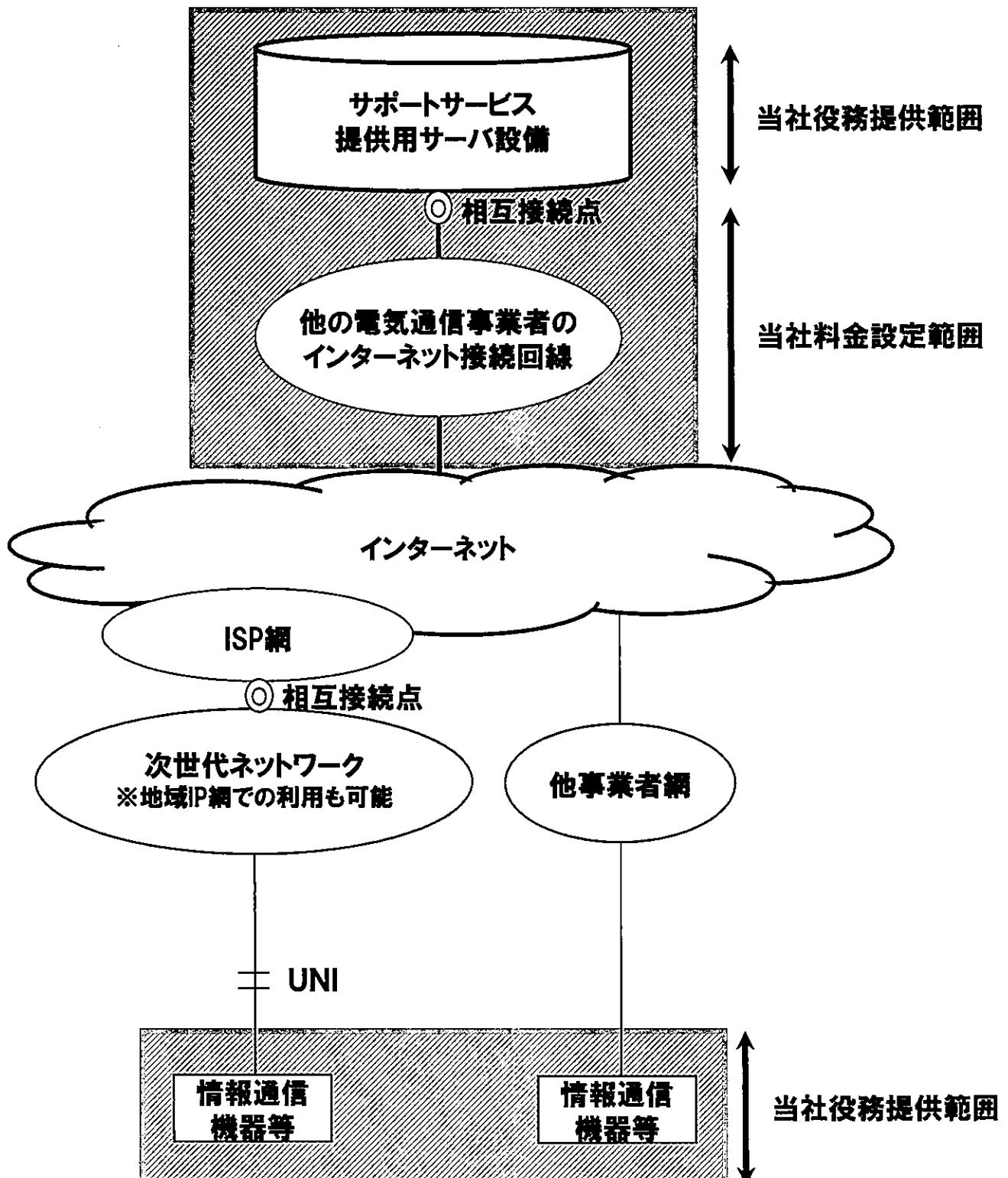
※UNI(User-Network Interface)…ユーザー(端末機器)とネットワークを接続するためのインターフェース。
