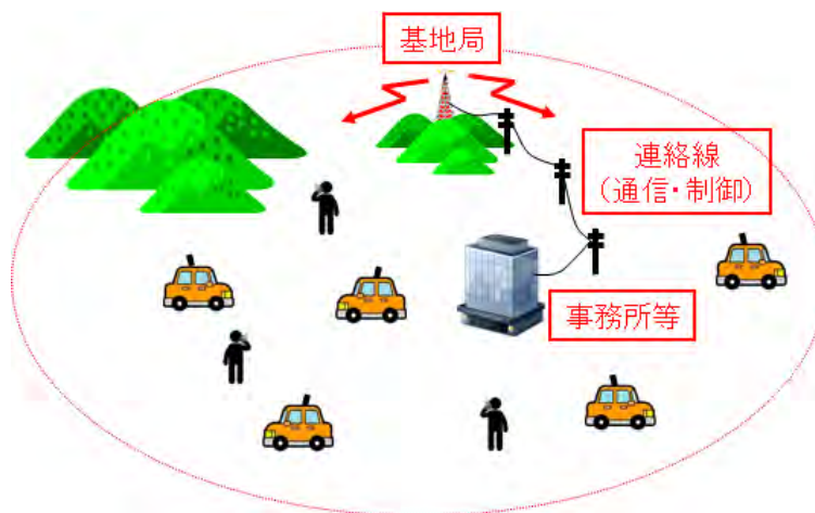
基地局を条件の良い山に設置 遠隔回線がないため高い山には設置できないケース
