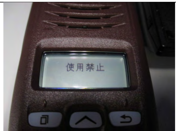
使用禁止コマンドを受信した無線機は、使用禁止状態になった。(LCD 照明も点灯しない状態のため照明をあてて撮影)
