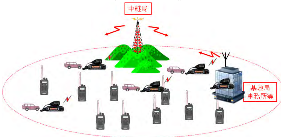
デジタル業務用無線通信システムの構成
