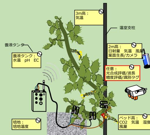
実際のビニールハウス及び実験用室内プラントにて、過去の設備制御型の方法ではなく収量・品質（糖度や苦み等）・育成期間等を効果的にコントロールする 生体プログラムの開発を行うと共に、農作物自体の状況を把握するための生体センサーや ICTを利用したデータ連携等の仕組みも開発して、農作物栽培最適化支援システムのビジネスモデルを確立します。
