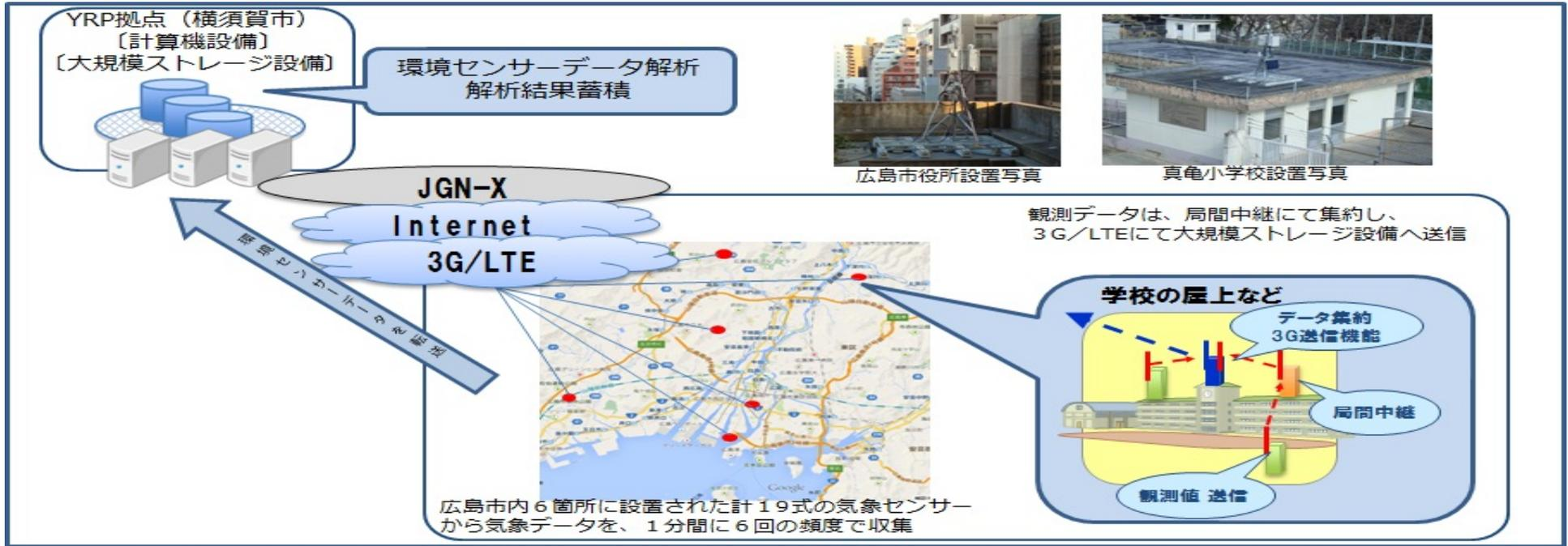
JOSE(Japan-wide Orchestrated Smart/Sensor Enviromnet)(大規模スマートICTサービス基盤テストベッド) : 広域に配備された複数種のセンサーから得られる観測データを、高速ネットワークで結ばれた分散拠点上の分散計算機を用いてリアルタイムに処理・解析するサービスを実装し、フィールド実証することが可能なテストベッド。
