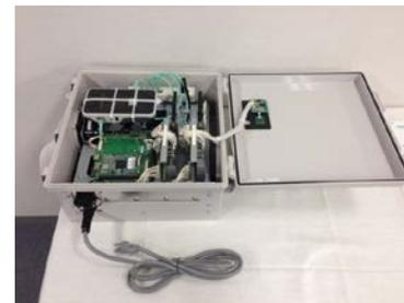
Wi-SUN基地局には転倒センサーへの通信機能、監視カメラ、雨量計、温湿度計を搭載。
