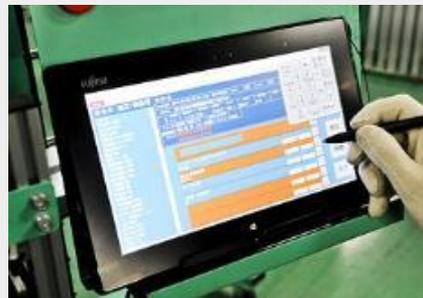
手順を工作機械脇に置いたタブレットでチェックしながら作業。ペン操作なので手袋でもスムーズに操作可能
