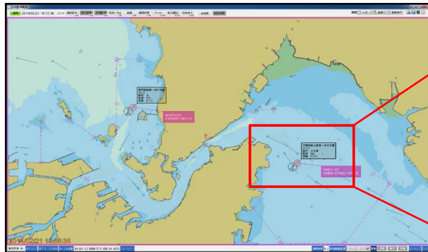
AIS対応電子海図装置によるAIS搭載船舶 及び航路標識AISの表示画面(例)
