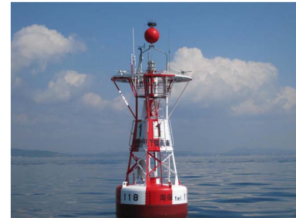
航路標識AISを搭載したブイ(一例) (下関南東水道第1号灯浮標(安全水域標識))
