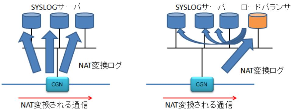
図 2-1 SYSLOG サーバ構成例
