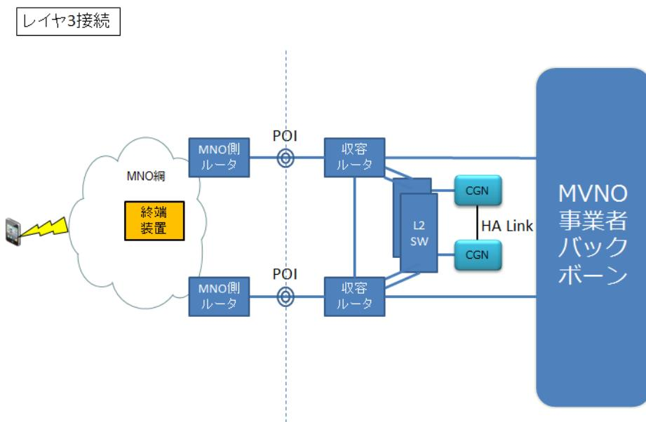
図 2-3 MVNO 事業者レイヤ 3 接続 CGN 構成例
