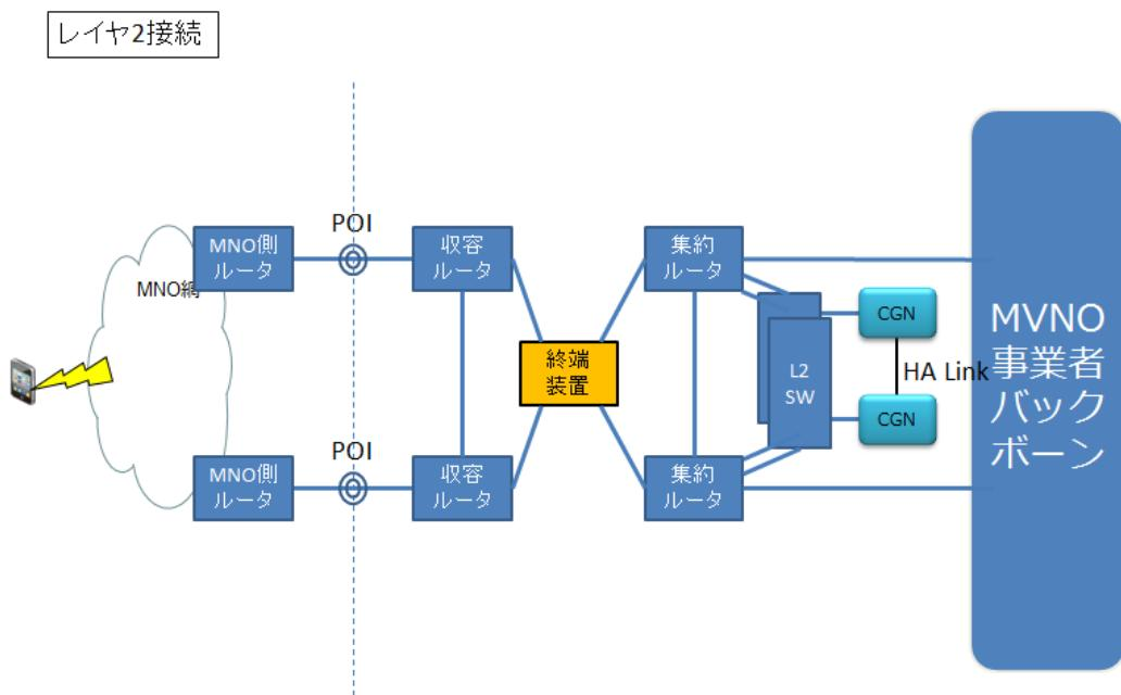
図 2-4 MVNO 事業者 レイヤ 2 接続 CGN 構成例
