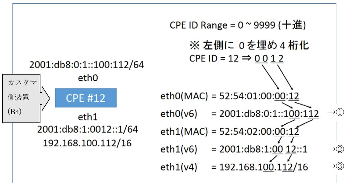
図 3-2 カスタマ側装置のアドレス設定例 (CPE #12 の例)
