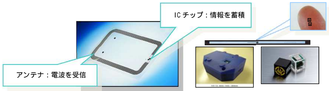
図 2-2. RFID 受信側システム基本構成
