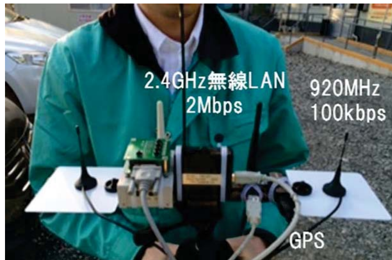
図 付 3- 3 三脚に固定した受信機の様子
