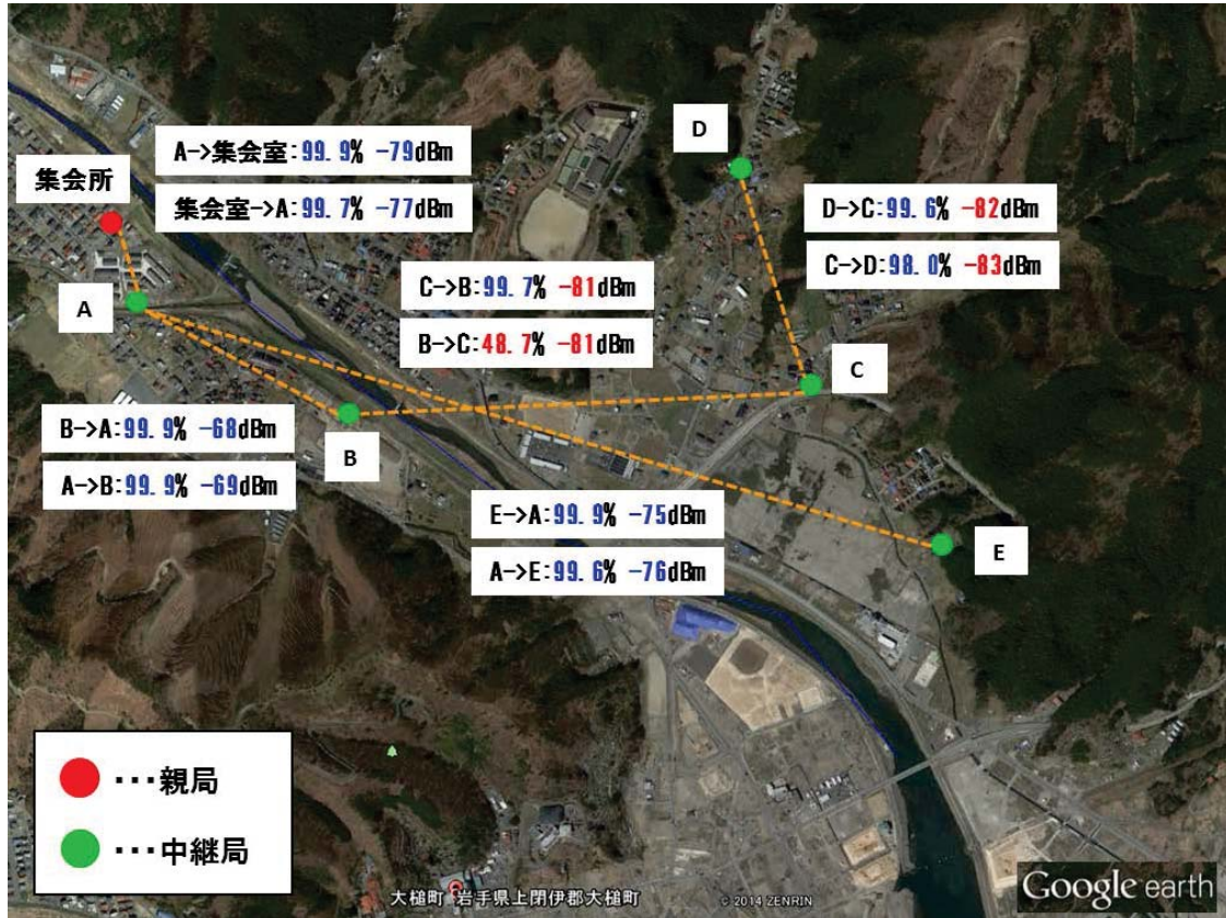
図 5-5 電波伝搬の測定結果
