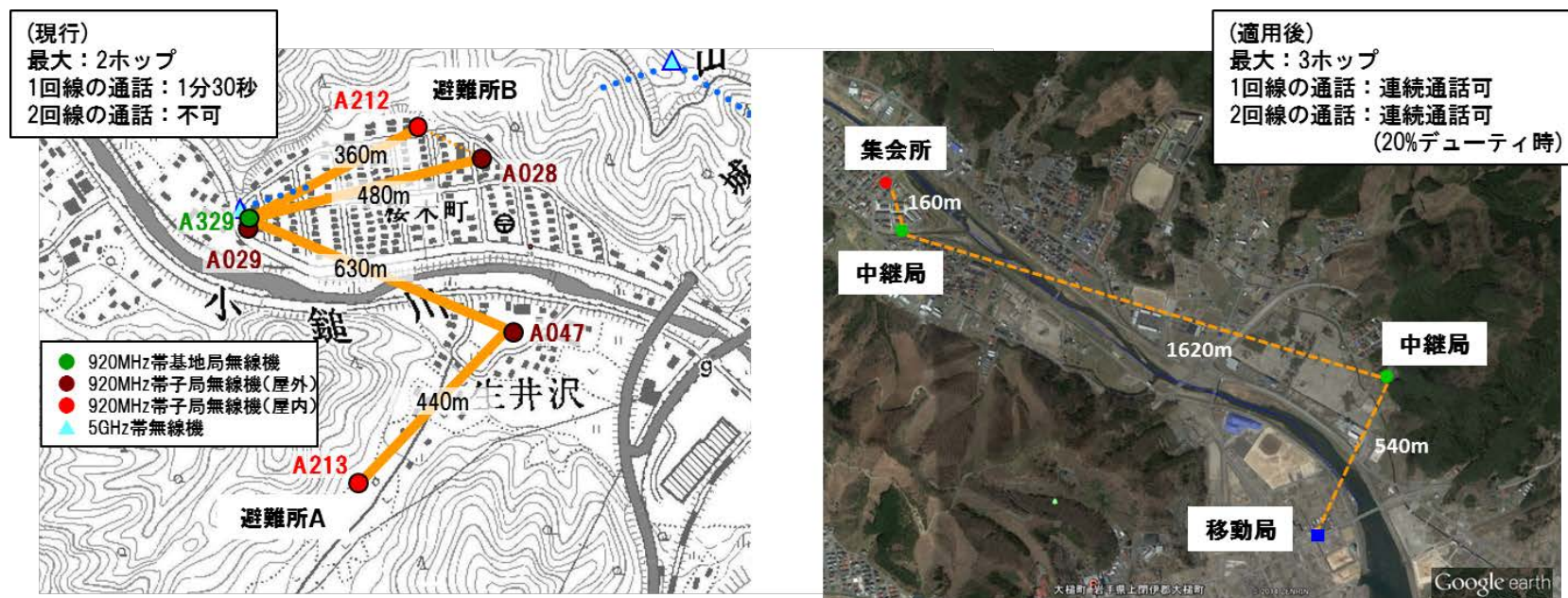
図7-1本調査検討会で用いた920MHz帯無線センサーネットワークシステムの構成
