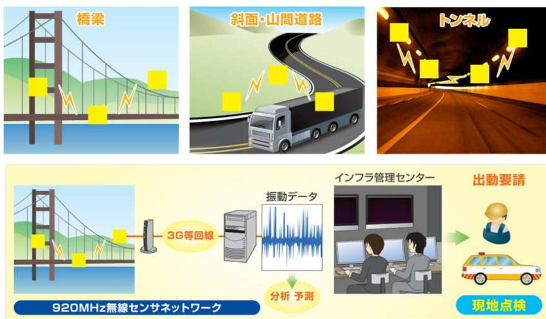
図 2-8 社会インフラモニタリングへの適用事例
