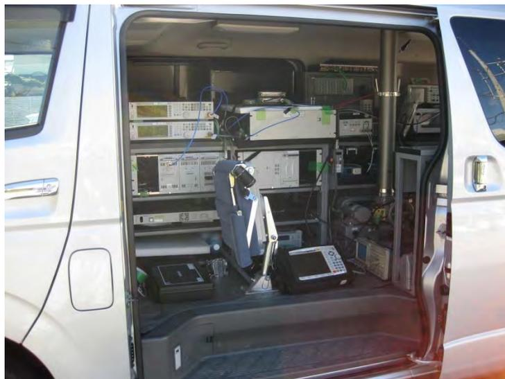
図 5.4-31 電波測定車に実装した STL 受信装置
