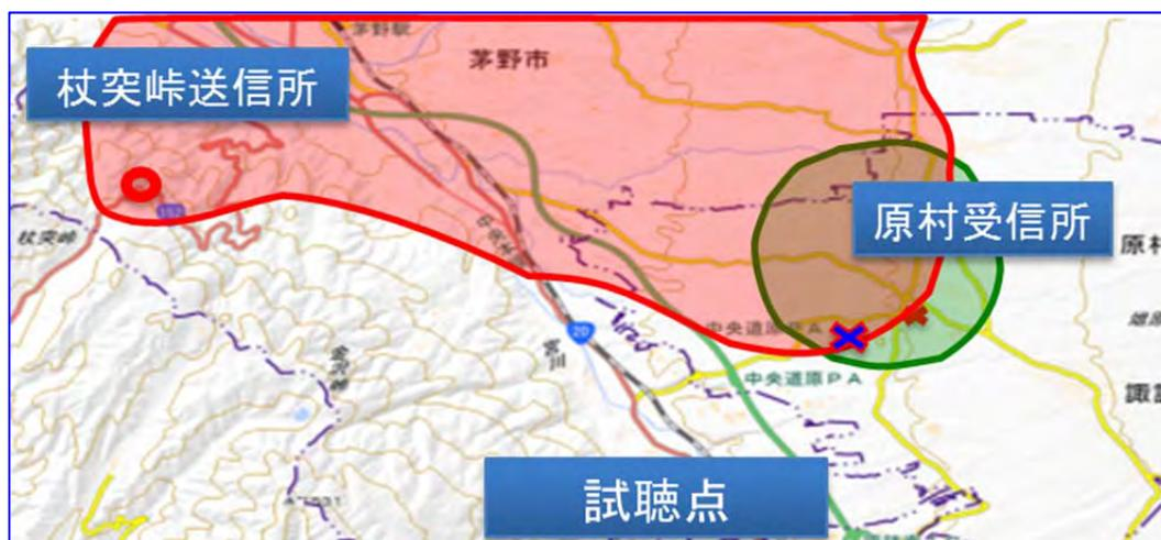
図 7.2-5 2 局の FM 実験試験局のエリア図( $48\text{dB } \mu\text{V/m}$ )と実験箇所
