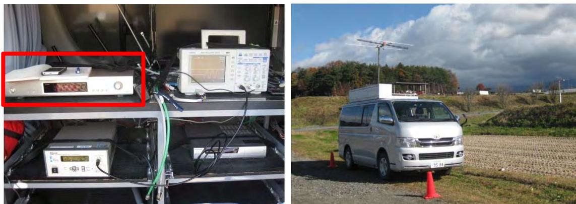
図 7.3-2 電波測定車内の機材(赤枠が FM 受信機)と、電波測定車での測定風景
