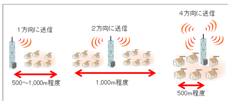
図3 地上デジタルテレビのギャップフィルターの例
