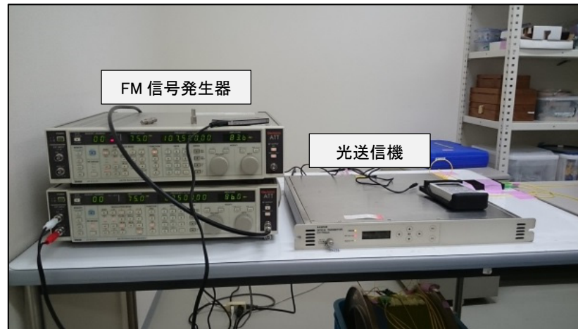
図 4.7.1 FM 信号発生器と光送信機
