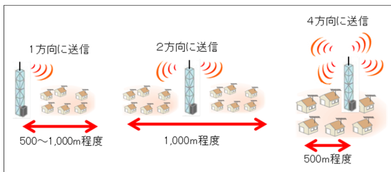
図3 地上デジタルテレビのギャップフィラーの例
