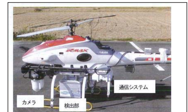
図2-2-2 無人ヘリコプターによる放射線モニタリングシステム
