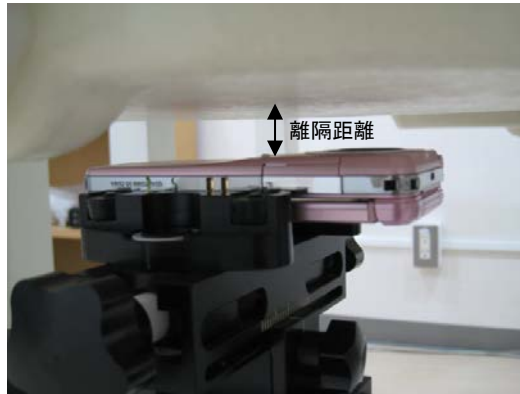
図 6.1 測定対象無線機器の設置例
