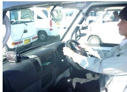
FMラジオによる受信品質を評価中
