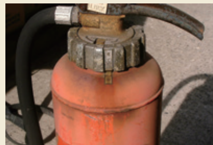
長い間放置され腐食の進んだ消火器
