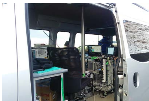
試作無線装置車載状況
