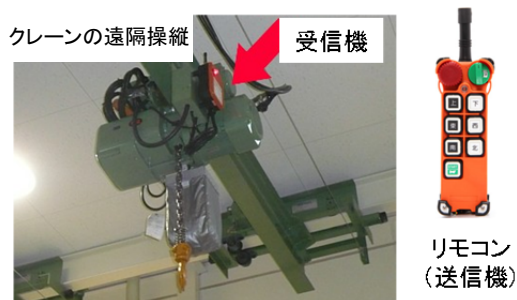
図 3-5 テレコントロールの利用例
