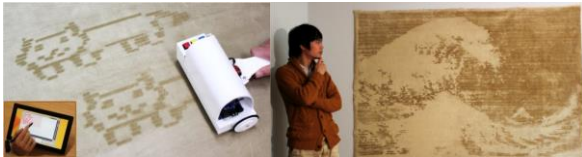
図 5 柔軟物の毛羽立ちを利用したディスプレイ
