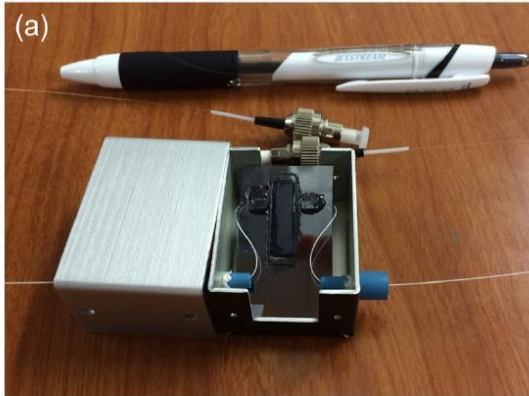
図 3 テーパ光ファイバとシリカトロイド微小光共振器をパッケージングした素子の写真。
