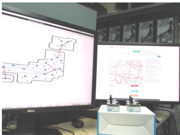
図2 構築したプロトタイプ・システム全景。右画面は、ユーザ端末画面を表示。左画面は、大規模センサネットワークトポロジと通信トラフィックを表示。手前は、試作したリコンフィギャラブル小型無線センサノード群。
