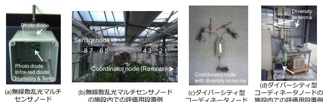
図1 429MHz IEEE802.15.6 方式無線センサ/アクチュエータノード
