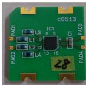
図 3-9 RF-DC 変換回路基板
