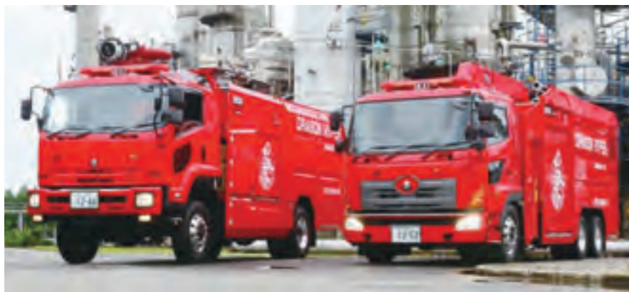
ドラゴンハイパー・コマンドユニットの中核車両である大型放水砲車(左)と大容量送水ポンプ車(右)
