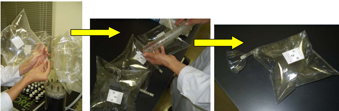
図-2 三点比較式臭袋法の試料調整
