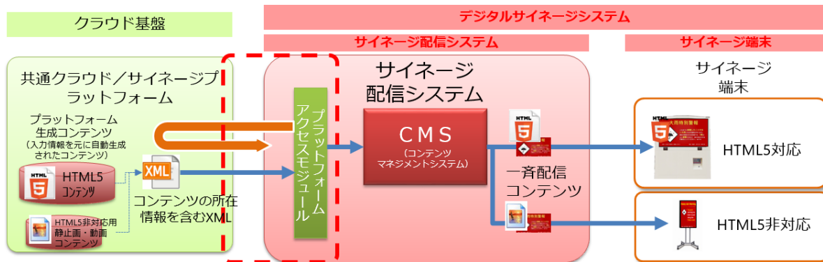
図 4.2-2 サイネージ配信システム・サイネージプラットフォーム連携 (PULL 型) システム基本構成
