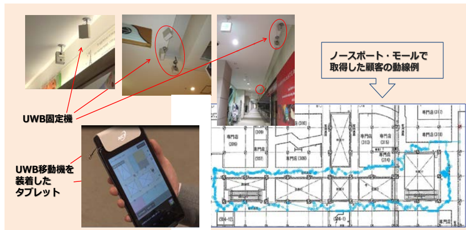
ショッピングモール(横浜)での屋内測位システムの実装と評価例
