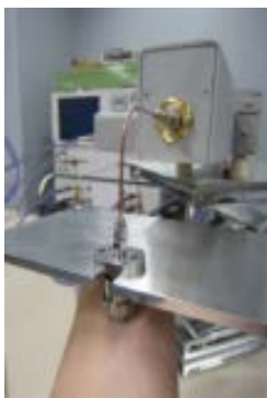
ミリ波帯用同軸プローブ法による生体組織の電気定数測定システム
