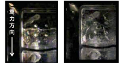
地上試験(1G環境) 飛行試験(μG環境) S-310-43号機の実験で取得された画像(右)及びそれに対応する条件で行った地上試験の画像(左)
