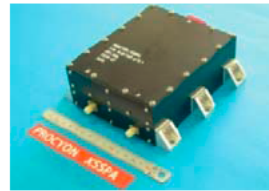
PROCYON搭載のX帯GaN 固体増幅素子 (GaN SSPA)
