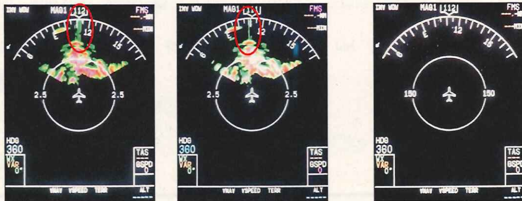
5 NMレンジ 同周波数運用 離隔距離は137 m（メインローブ 対 サイドローブで評価） 5 NMレンジ 離隔周波数2.5 MHz 300 NMレンジ 同周波数運用
