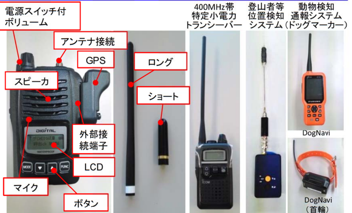
(a)無線機外観 (b)アンテナ外観 (a)比較検討用 (b)共用検討用 図4-1 試験装置(地域コミュニティ無線) 図4-2 その他無線機
