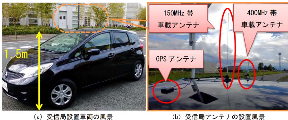
図 4-8 受信局の設置状況
