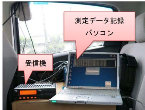
図 4-13 車内設置風景
