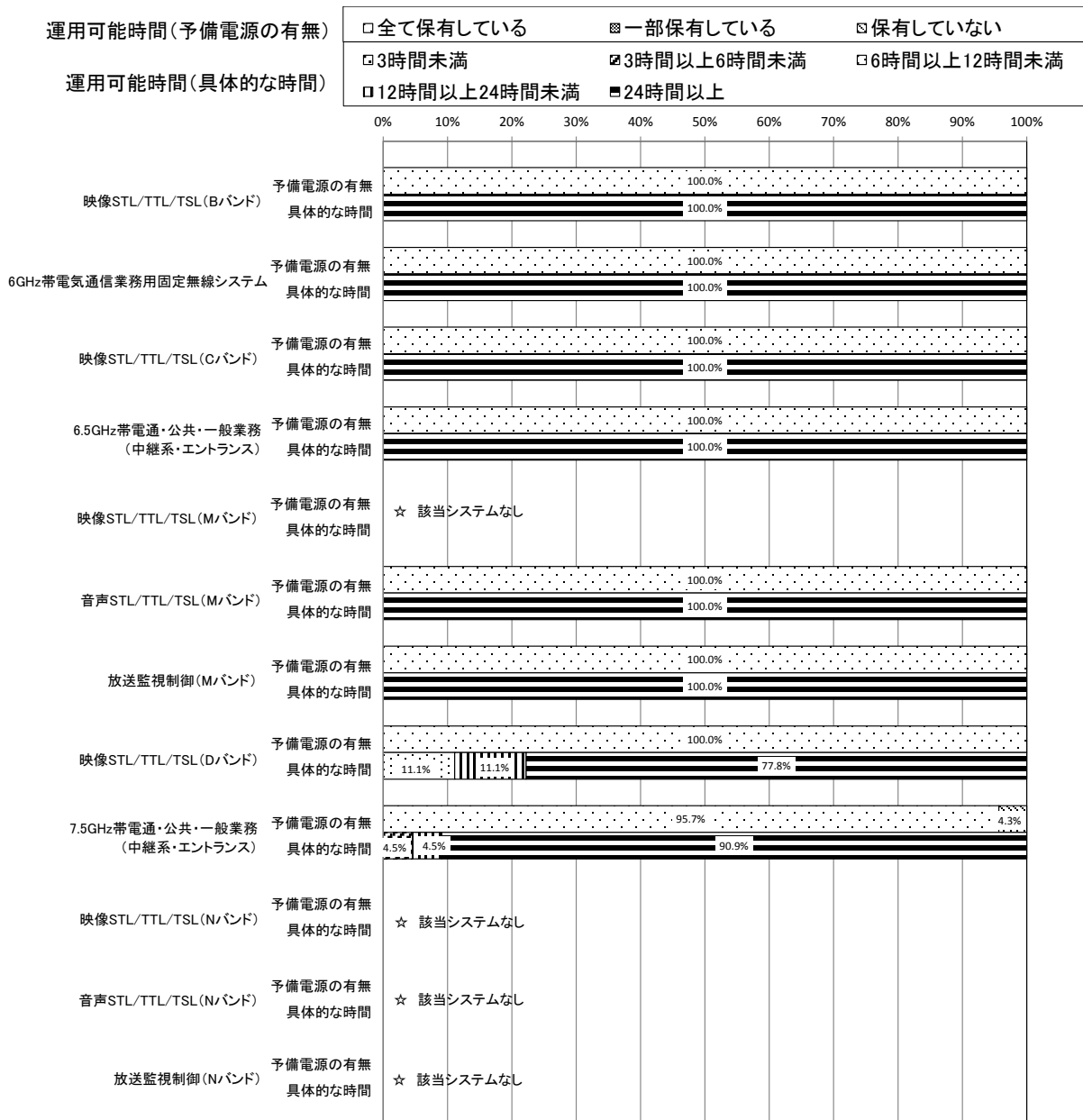
図表一信一４－１０ 予備電源保有状況及び予備電源の最大運用可能時間【信越】
