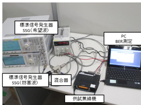
図 4-16 近接チャンネル干渉測定の様子
