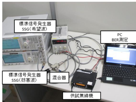
図 4-11 隣接チャネル干渉測定の様子
