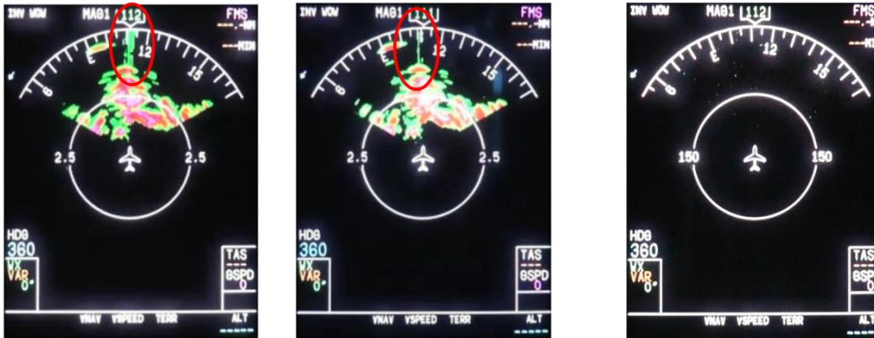
5 NMレンジ 同周波数運用 5 NMレンジ 離隔周波数2.5 MHz 300 NMレンジ 同周波数運用 離隔距離は137 m（メインローブ 対 サイドローブで評価）
