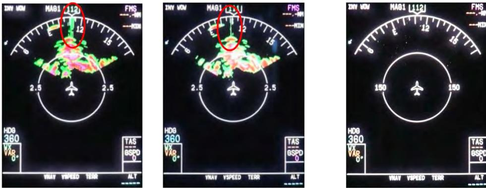
5 NMレンジ 同周波数運用 離隔距離は137 m (メインローブ 対 サイドローブで評価)
