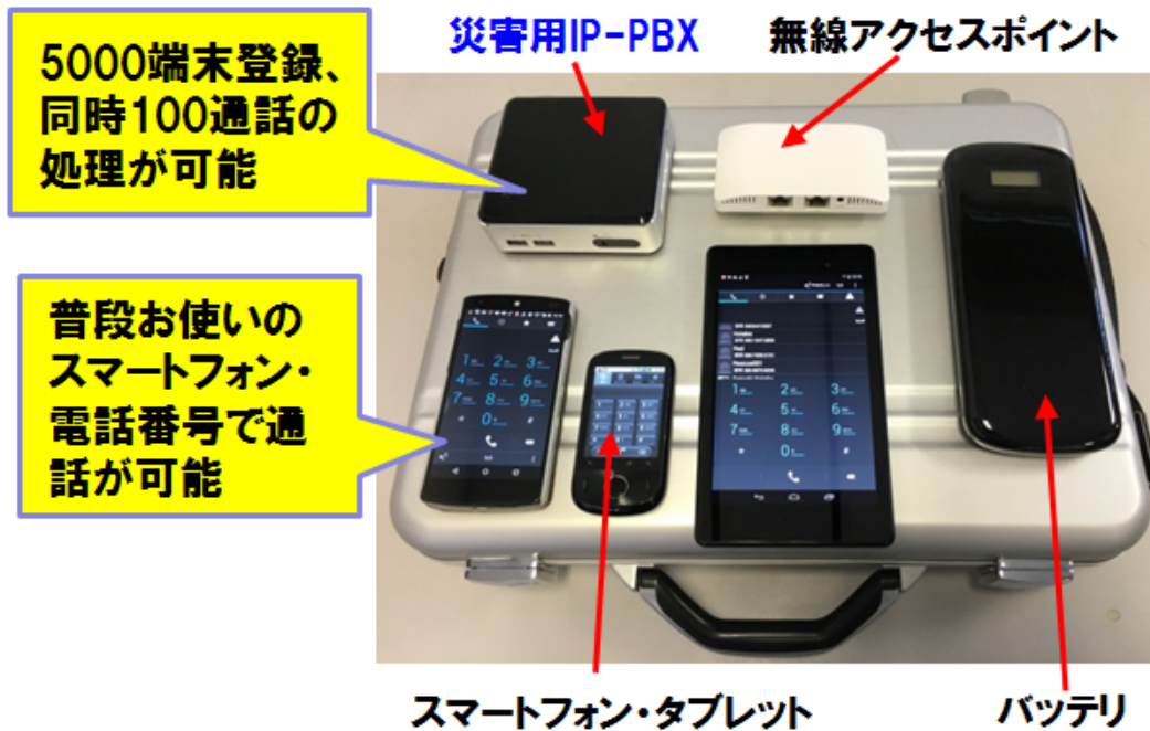
図：アタッシュケース型 ICT ユニット「ポータブルIP-PBX」 (総務省及びNTTの研究開発により実用化・製品化したもの)
