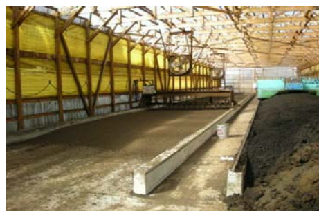
写真5 毎日攪拌し、好気性菌で堆肥化
