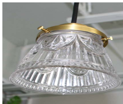
障害原因となったハロゲン照明
