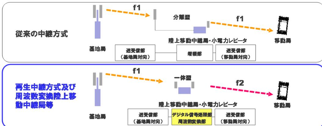
図2. 3. 1-2 従来の中継方式と新中継方式の比較
