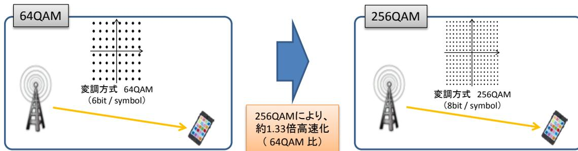
図 2. 2. 1-1 下り256QAM化の概要
