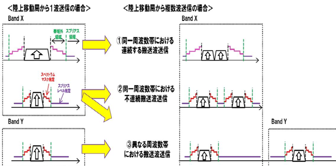
図2. 1. 2-1 上りキャリアアグリゲーションにおける空中線電力、不要発射強度の考え方
