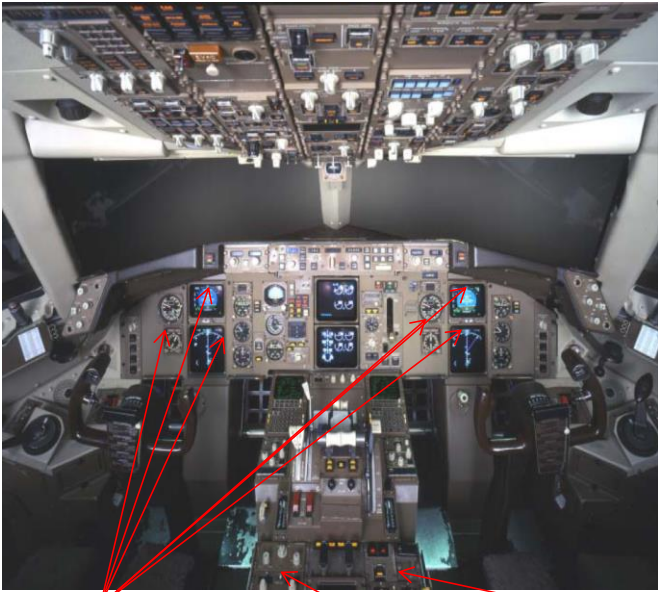
コックピット内の無線設備配置例
