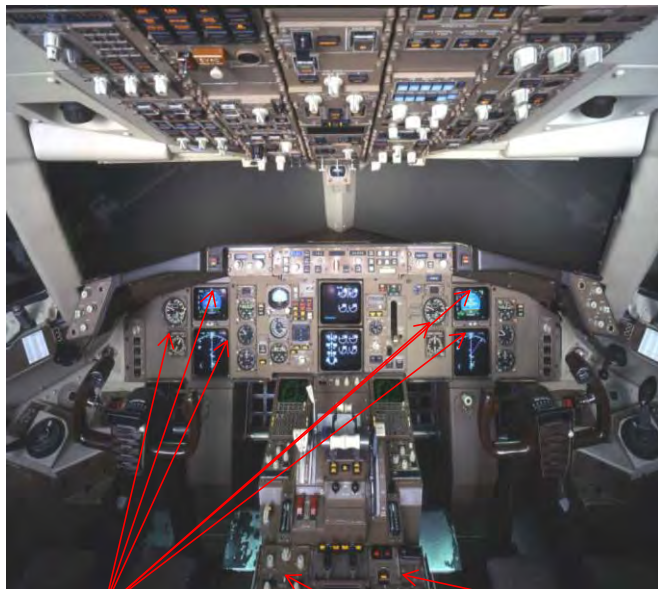
コックピット内の無線設備配置例
