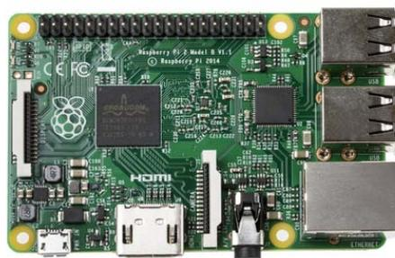
図 4-9 RaspberryPi 第二世代、Raspberry Pi 2 Model B<sup>16</sup>
