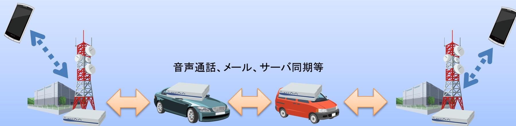
自治体施設など災害時の拠点施設間に車載通信機を搭載した車を数珠繋ぎ状に固定配置し、車載通信機間でアドホック通信ネットワークを構築することにより、両拠点間に定常的なデータ通信経路を確立する。
