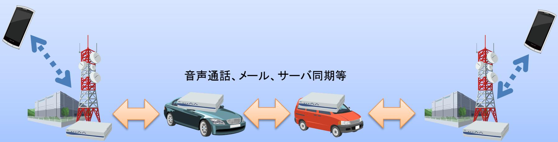
自治体施設など災害時の拠点施設間に車載通信機を搭載した車を数珠繋ぎ状に固定配置し、車載通信機間でアドホック通信ネットワークを構築することにより、両拠点間に定的なデータ通信経路を確立する。
