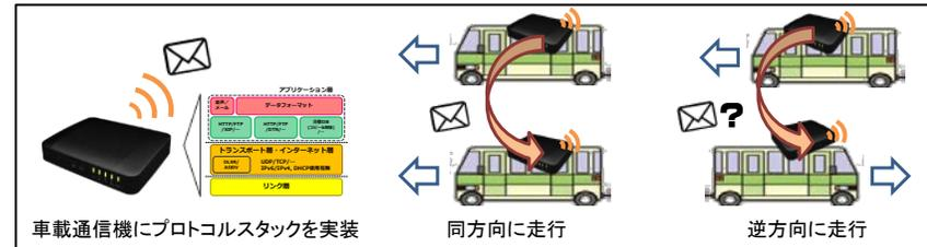
実証試験例(アドホック通信ネットワークの基本機能の検証)
