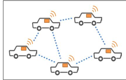
自動車同士が相互に直接接続し、アドホック通信ネットワークを構築
